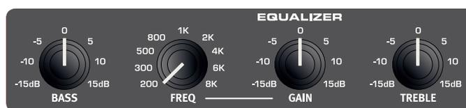
C'est un égaliseur 3 bandes possédant des commandes de graves (Bass), de médiums glissants (Freq/Gain) et d'aigus (Treble). La fréquence de correction des graves (**BASS**) est de 100 Hz, celle des aigus (**TREBLE**) de 4 kHz et celle des médiums peut être réglée entre 200 Hz et 8 kHz au moyen du bouton **FREQ**. La plage d'amplification/atténuation est de +/-15 dB.
