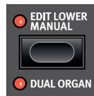
Pressez **DUAL ORGAN** (Shift + Edit Lower Manual) pour créer instantanément une configuration d'orgue à double manuel, avec le clavier partagé en deux zones. Le manuel inférieur (**LO**) se trouvera à gauche du point de partage et le manuel supérieur (**UP**) à sa droite.
