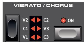
Le scanner de vibrato et de chorus de l'orgue à roues phoniques original est constitué d'une ligne de retard modulée combinée avec un scanner tournant. Pour l'effet Vibrato, un déphasage est appliqué au signal. Pour l'effet Chorus, un signal à phase modulée est ajouté au signal d'origine.
