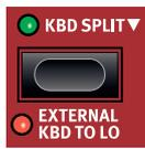
Le clavier du Nord Electro 6 peut être divisé en deux zones, appelées **LO** (basse) et **UP** (haute), séparées par le *point de split*. Chaque moteur audio (Organ, Piano ou Sample Synth) peut être assignés à une de ces zones ou aux deux.
