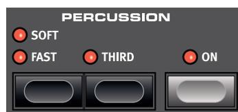
Pressez la touche Percussion **ON** afin d'ajouter une attaque supplémentaire au son du B3 en utilisant un générateur d'enveloppe simple pour contrôler la 2e ou la 3e harmonique.
