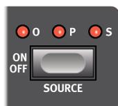
Sélectionnez le moteur audio auquel l'égaliseur doit être affecté en pressant **SOURCE** (Shift + On/Off) jusqu'à ce que la LED de la source désirée (Organ = **O**, Piano = **P** et Sample Synth = **S**) s'allume.
